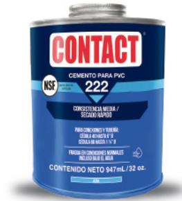
**DESCRIPCIÓN:** Solución de resina de PVC con disolventes apropiados, que al secar por evaporación de solventes realiza la fusión de las superficies y su unión permanente, dejando una sola pieza como resultado CONTACT 222, es color azul lo cual permite verificar su aplicación y su mezcla de solventes está diseñada para fraguar condiciones humedad.
